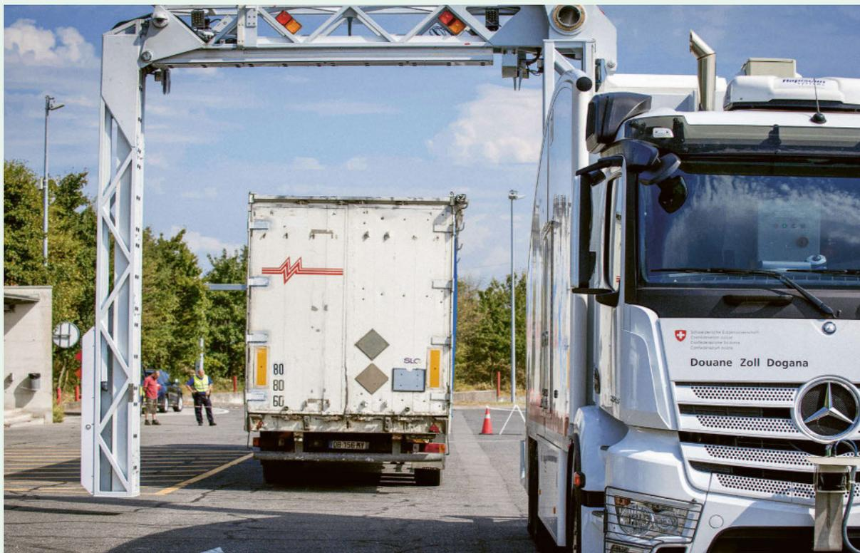
Le scanner mobile permet de repérer les marchandises cachées non seulement dans le chargement, mais aussi dans les structures, la cabine et les portes.
