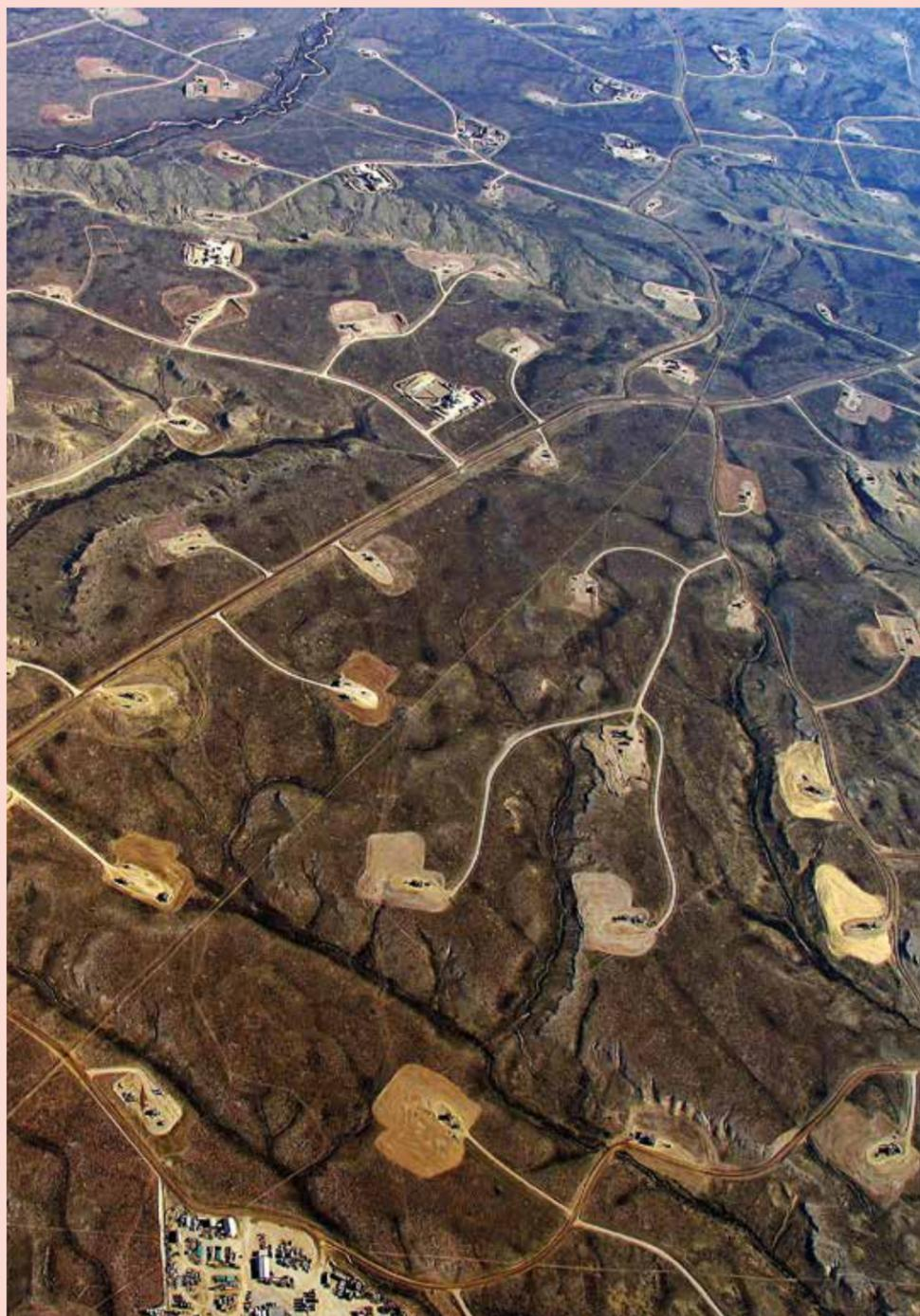
*Réseau de puits de fracturation dans le champ pétrolier et gazier de Jonah, Wyoming.*
